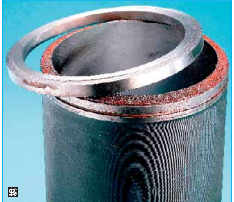
Rotura forzosa del collar
