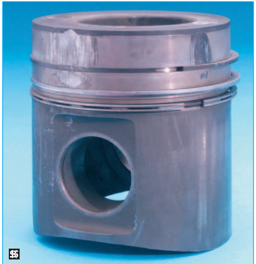
Fig. 1: Ranuras de agarrotamiento en la pared de fuego
